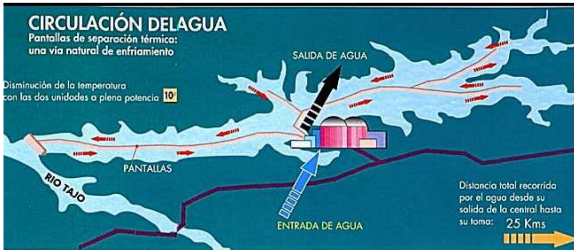
Figura 2. La riserva di acqua Arrocampo sul fiume Tago che raffredda la NPP Almaraz. (5)
