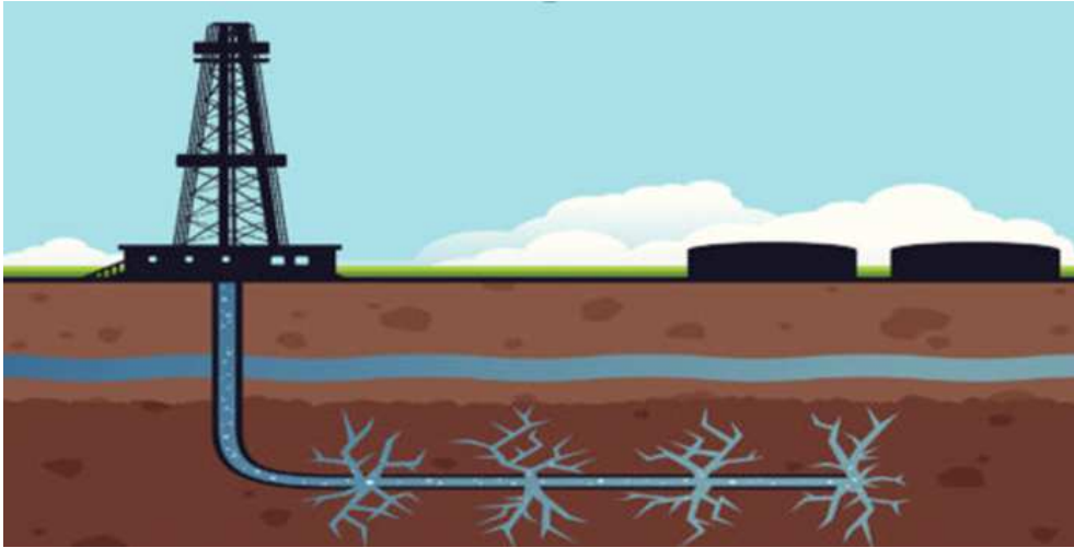
Рисунок 30. Фрекинг с образованием “радиальных трещин”. (69)
