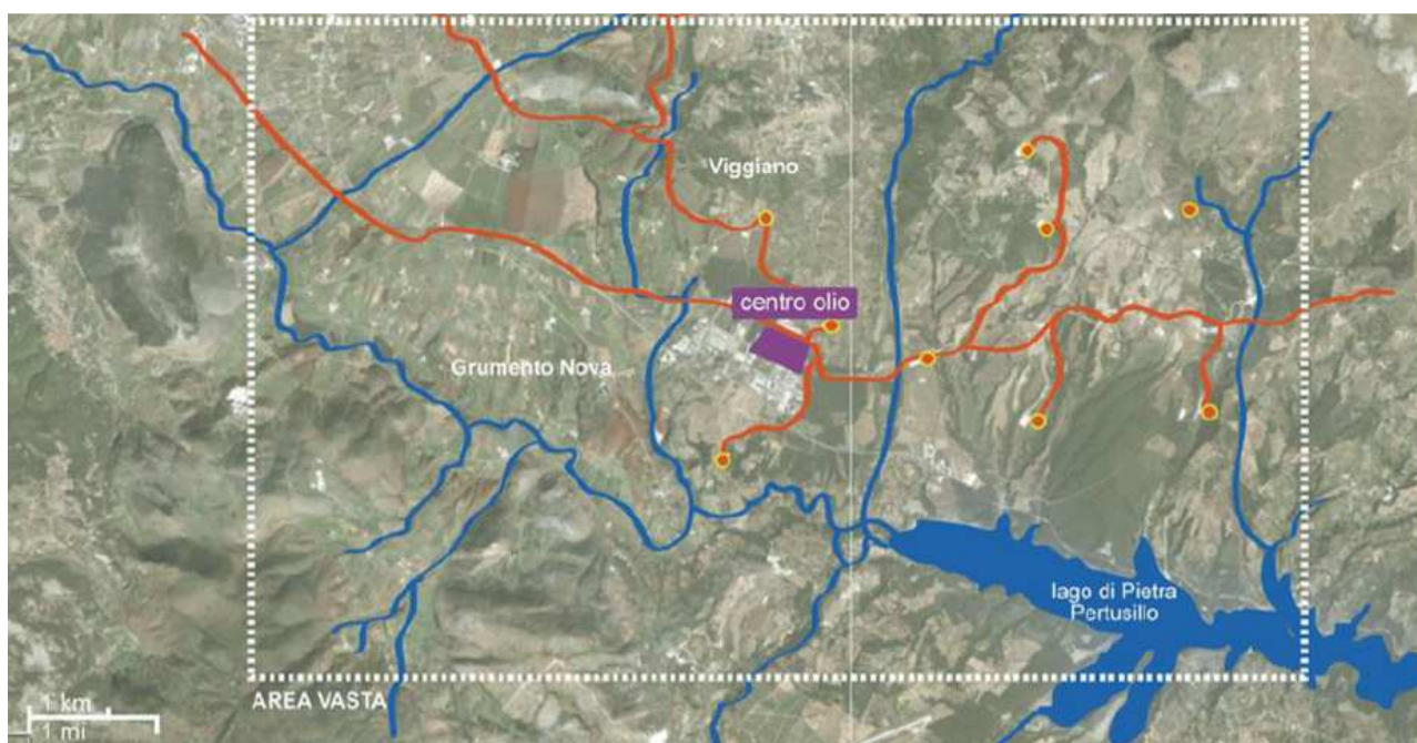
Figura 36. Area circostante il C.O.V.A. con Pozzi, rete di raccolta e reticolo idrografico, Osservatorio Ambientale Val d’Agri, 2015. (105)
