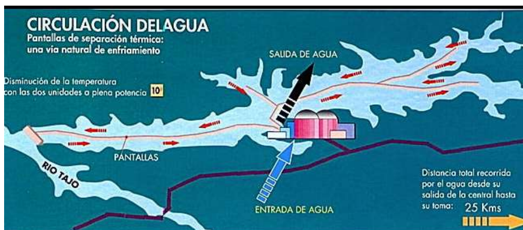
Figura 2. La riserva di acqua Arrocampo sul fiume Tago che raffredda la NPP Almaraz. (5)
