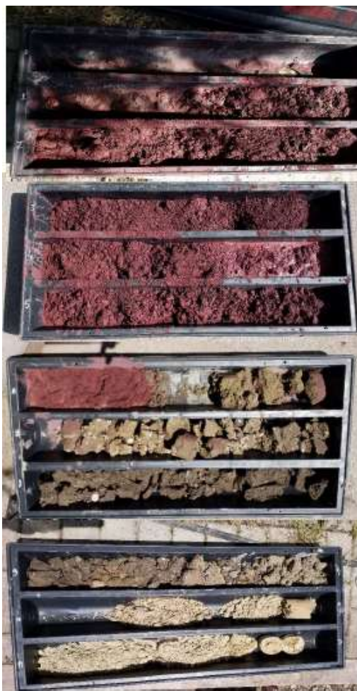
Figura 12. Carotaggi del terreno con rifiuti interrati lungo il perimetro del sito industriale dismesso ex Montecatini in località Piano d'Orta di Bolognano vicino al fiume Pescara , maggio 2018,
