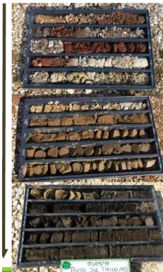
Figura 9. Discarica Tre Monti , rifiuti (fino a 7 m), depositi palustri saturi contaminati (fino a 16 m) e depositi insaturi (fino a 20 m) (21)
