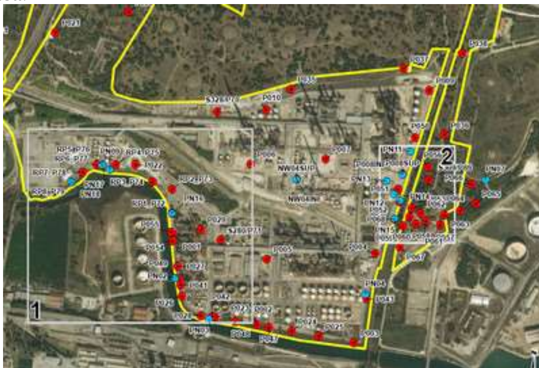
Figura 38. Pozzi di monitoraggio negli impianti SASOL di Augusta, RAFFINERIA ISAB SUD , RAFFINERIA ISAB NORD , RAFFINERIA ESSO di Augusta. (101)
