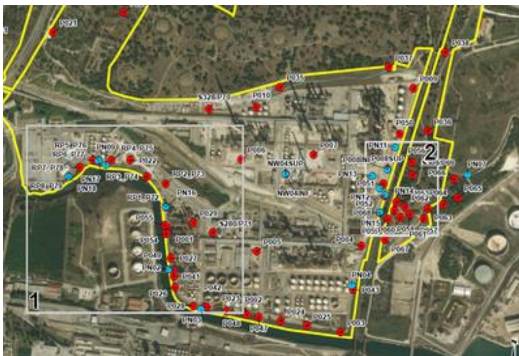
Рисунок 38. Мониторинговые скважины на заводе SASOL в г. Аугуста, Нефтеперерабатывающие заводы ISAB SUD, ISAB NORD, ESSO Аугуста. (101)
