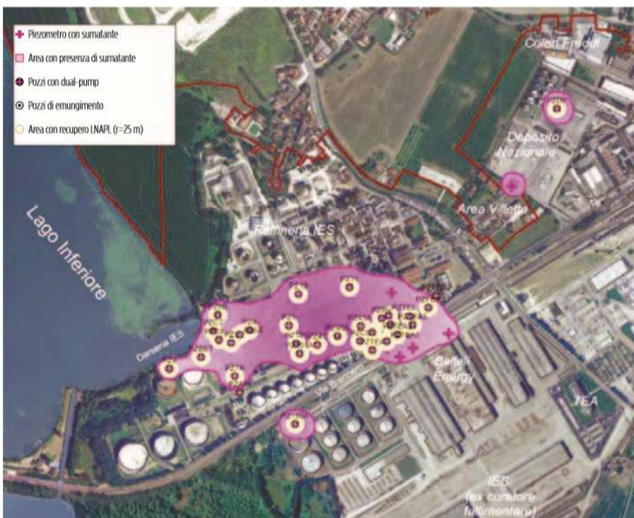
Рисунок 16. Распределение смеси плавающей и твердой фракций в нефтеочистительной компании IES г.Мантуя, июнь, 2009 г. Розовый крестик – пьезометр с загрязняющей смесью, розовый цвет – зона, где присутствует смесь (1)
